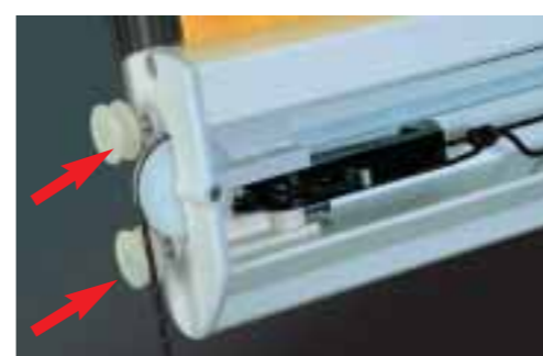
De loopwagen op wielletjes werd speciaal ontworpen om het systeem zachter te laten lopen en is dan ook zo goed als geruisloos. De wielletjes kunnen zijdelings bewegen, wat ervoor zorgt dat de voorlijst steeds soepel in de geleiders loopt.
